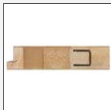
SKRZYDŁO 46 mm WZMOCNIŁO MASYWNYM CEOWNIKIEM STAŁOWYM
